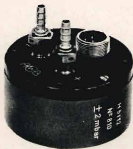
Fig. 1 - Manometro a variazione della mutua induzione: a = vista esteriore, b = schema di principio.
